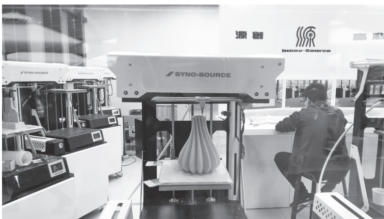
Fot. 2. Drukarka 3D stosowana do produkcji porcelany.
